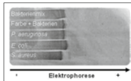
Abb. 6: Elektrophoretische Auftrennung von DNA aus den drei Bakterienstämmen, der Bakterienmischung, sowie aus der kontaminierten Dispersionsfarbe
